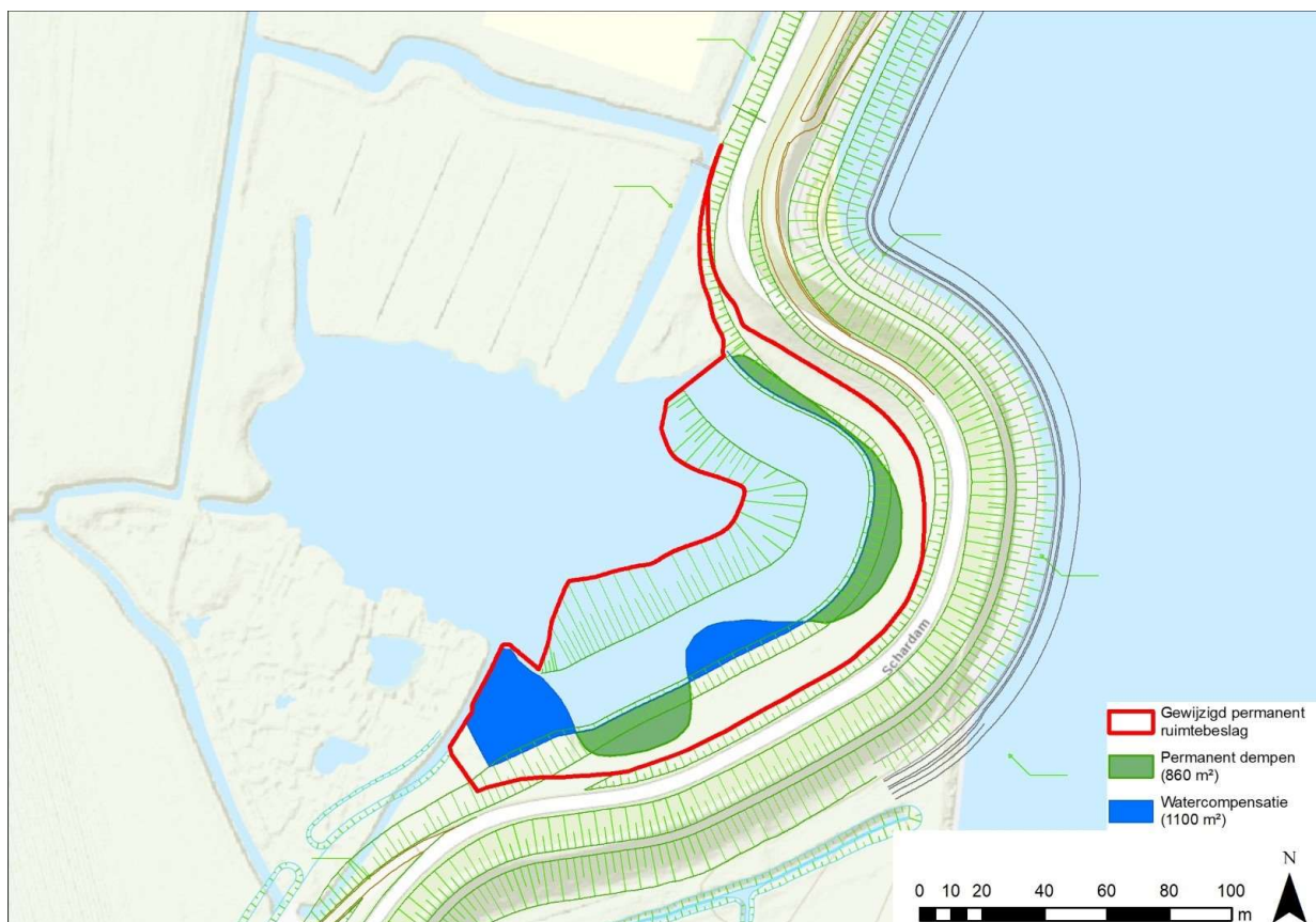
Figuur 2.1 Overzicht demping en watercompensatie
