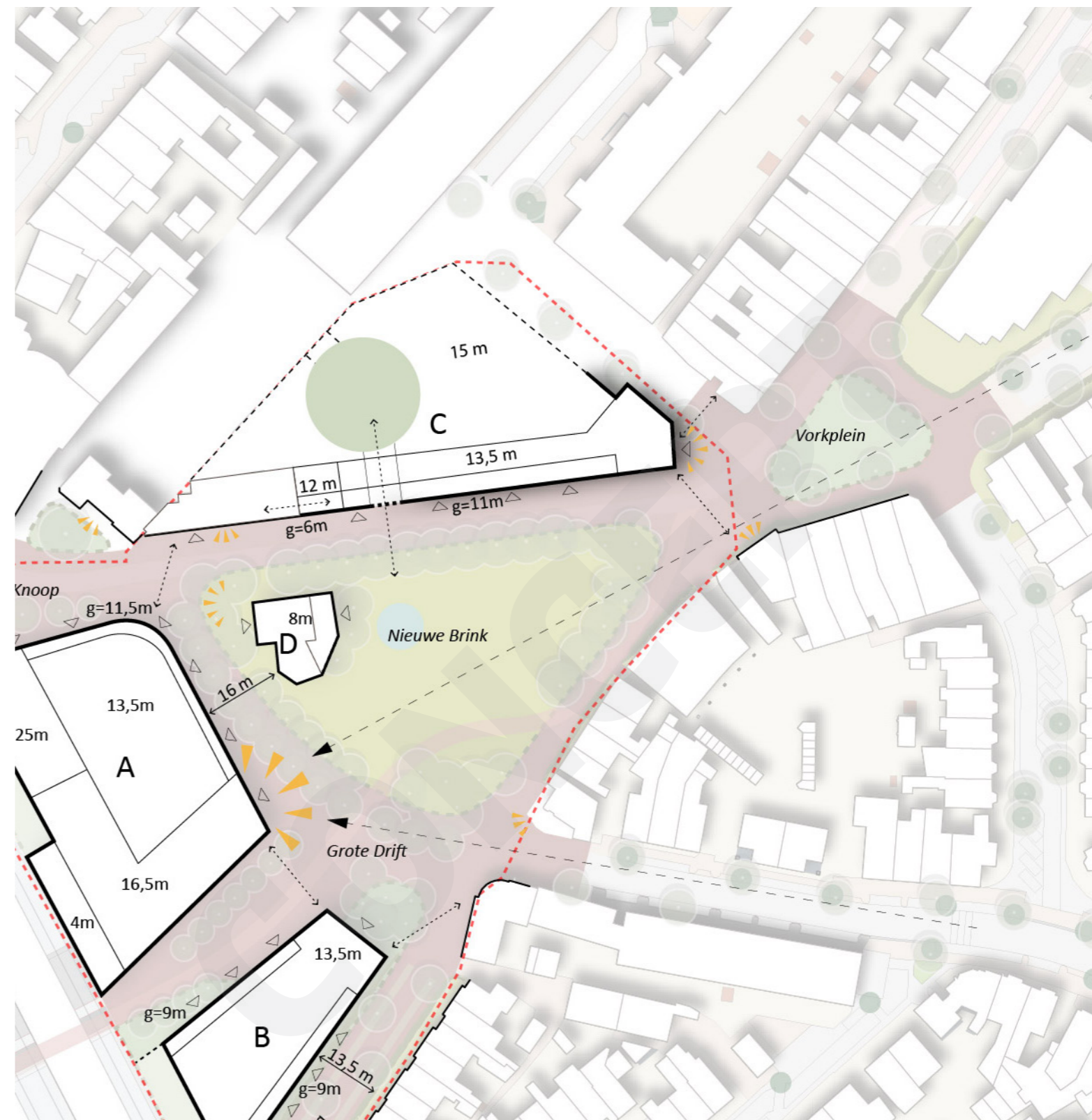
Tekening van gebouw C uitgelicht in zijn situatie met regels en criteria. Aangegeven bouwhoogtes t.o.v. de kruin van de weg.
