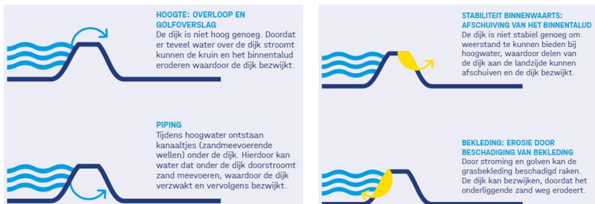
Afbeelding 2-1 Toelichting belangrijkste faalmechanismen voor IJsselwerken
