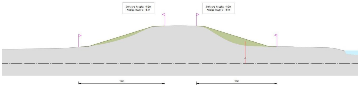
Zuid 1 Dwarsprofiel DWP 2.0-3 Schaal 1:200
