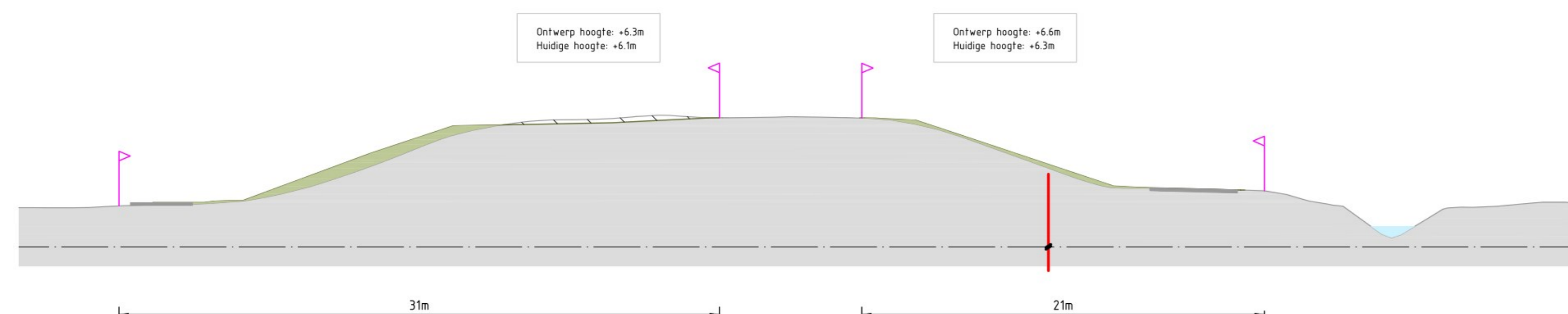
Midden-Zuid 2 Dwarsprofiel DWP 8-06a Schaal 1:200
