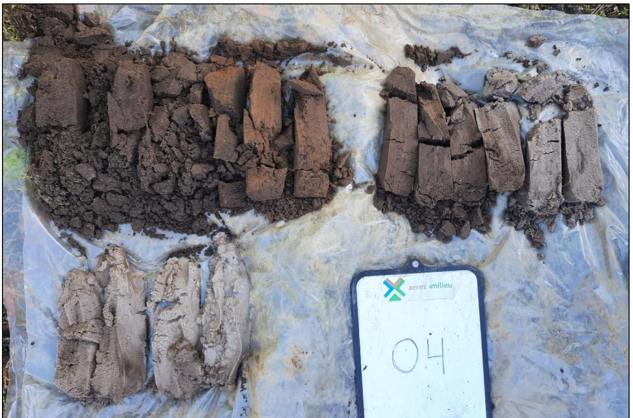
Figuur 4. Foto van boring 4. De leesrichting is van linksboven naar rechtsonder (0 – 150 centimeter) (Foto: 29 april 2024).
