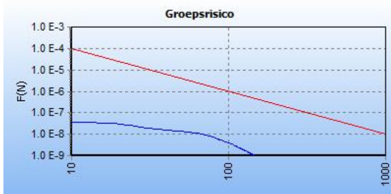
5.3 Figuur 5.3 FN curve voor 9345_leiding-A-663-deel-1 van N.V. Nederlandse Gasunie voor de kilometer tussen stationing 4530.00 en stationing 5530.00
