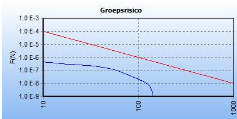
5.4 Figuur 5.4 FN curve voor 9345_leiding-N-559-16-deel-1 van N.V. Nederlandse Gasunie voor de kilometer tussen stationing 3490.00 en stationing 4490.00
