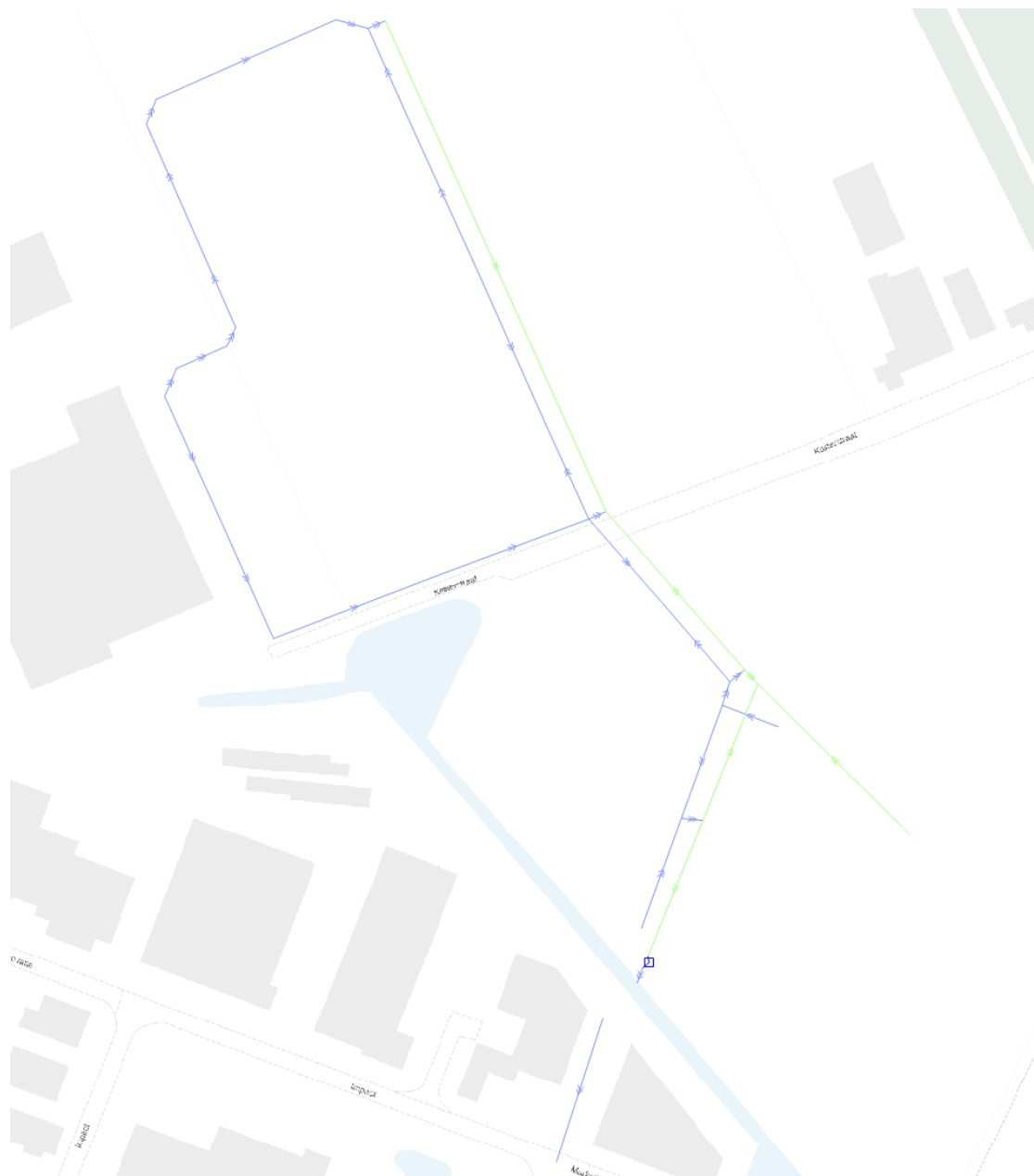
Figuur 5.7 Volumes water op straat (m3) bij 80 mm neerslag in 48 uur. Hierbij zie je dat er geen volumes op straat zijn aangegeven wat betekent dat er geen water op straat optreedt. Het hemelwaterriool is aangegeven met blauwe lijnen en het wadi-systeem met groene lijnen.
