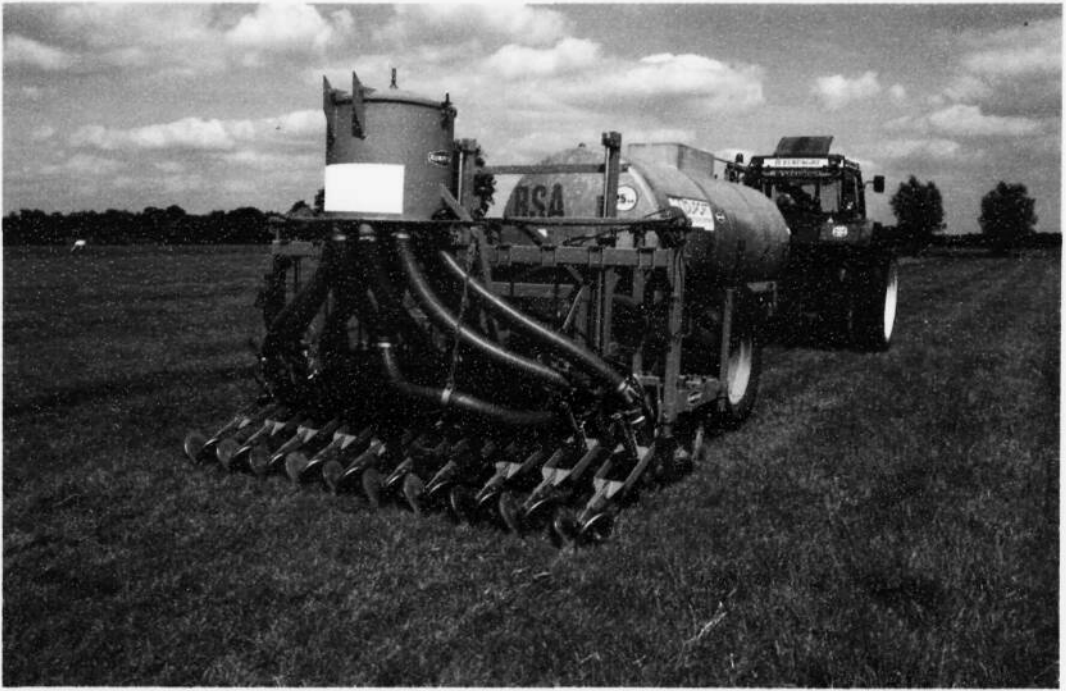
Door op grasland mest uit te rijden met behulp van een zode-injecteur kan de ammoniakuitstoot tijdens en na het aanwenden van dierlijke mest met circa 90% worden verminderd.
