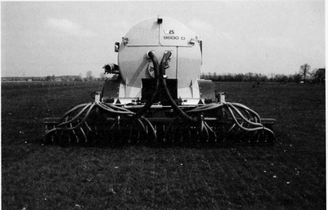
Door op grasland mest uit te rijden met deze zelfrijdende zodebemester kan een sterke reductie van de ammoniakemissie tijdens en na het aanwenden van dierlijke mest worden gerealiseerd.
