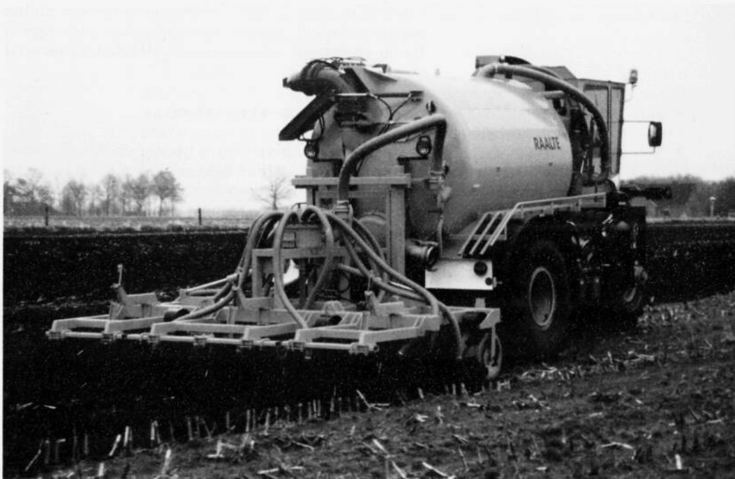
Het verspreiden en onderwerken van dierlijke mest op bouwland in één werkgang door middel van een bouwlandinjecteur vermindert de ammoniakemissie met 90% ten opzichte van normaal bovengronds uitrijden.
