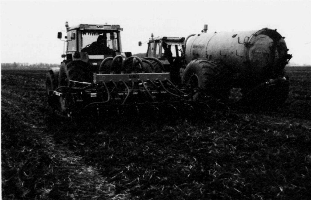
Een andere mogelijkheid om op bouwland de ammoniakemissie tijdens en na de aanwending van dierlijke mest sterk terug te dringen.
